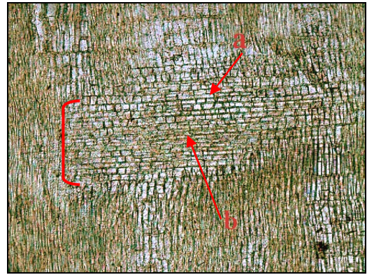
Figura 32. Radio heterogéneo: 2 hileras de células verticales marginales (a) y cuerpo recto de células procumbentes (b). Corte radial X100 A
